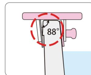
88°の角度設計により5mm程度の段差にも対応。
